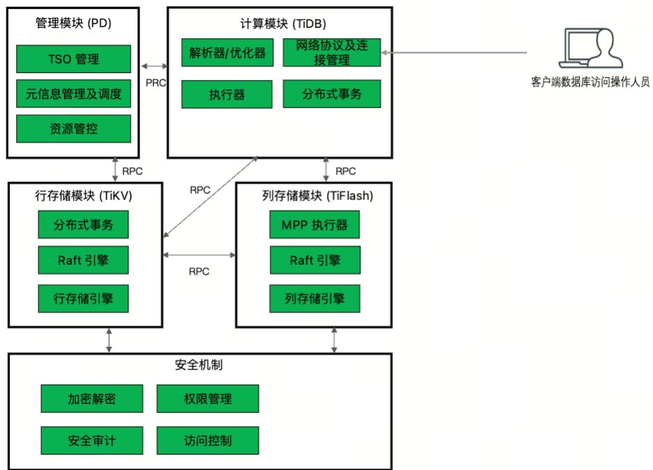
图 1: TiDB OpenCore Architecture
